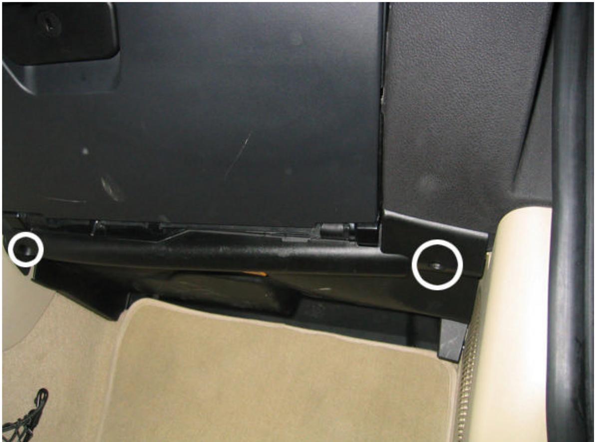
Bild 1: Schrauben der Abdeckung hinter dem Handschuhfach
