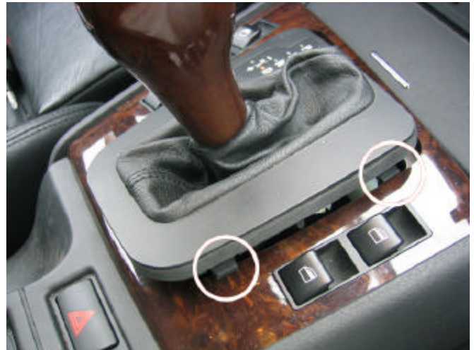
Bild 6: Schalthebelmanschette mit Klipsen
