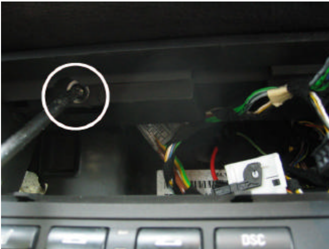
Bild 5: 2 Schrauben hinter Klimaeinheit lösen
