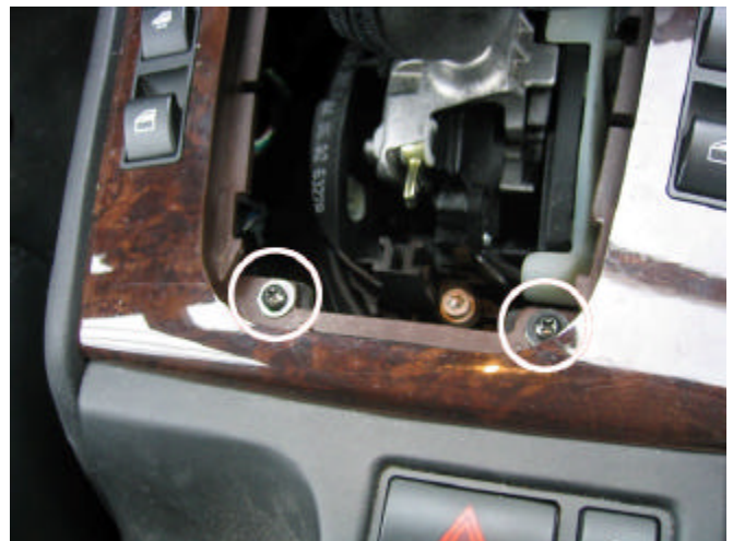
Bild 8: Schrauben unter der Schalthebelmanschette hinten
